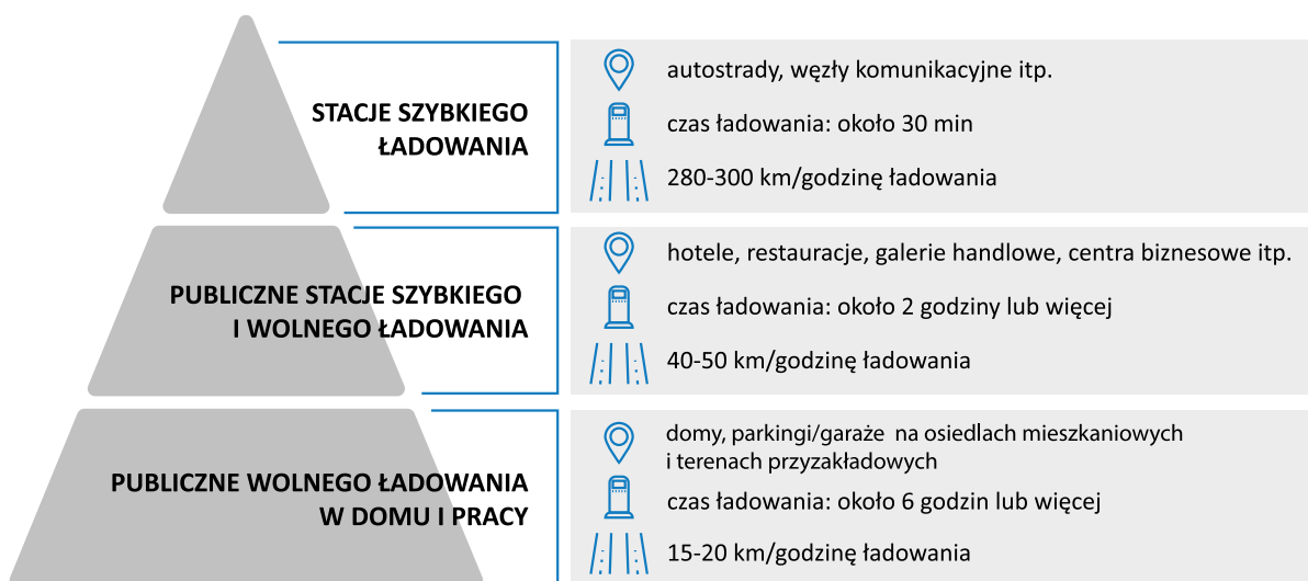
Rysunek 16: Mix infrastruktury ładowania pojazdów elektrycznych
